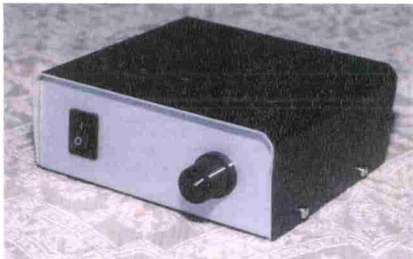
Så här kan buggen byggas, här i SM4ATJ version. Fem knappar på ovensidan styr minnen och olika funktioner och poten på framsidan hastigheten.
